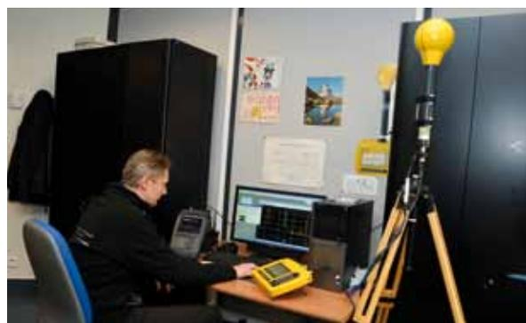
La DCE possède des équipements lui permettant d'établir une veille qualitative du spectre radioélectrique de Monaco et d'intervenir en cas d'interférences.
